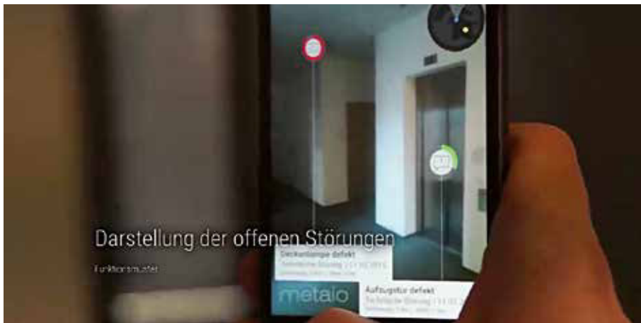
Augmented Reality: Reale Welt und digitale Informationen laufen auf dem Smartphone zusammen. In die Kameraaufnahme wird die Störmeldung für die Aufzugstür eingeblendet.
